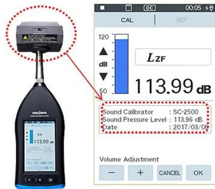
2. 校正モードをOKで完了すると、自動で、校正データが内蔵メモリに保存される。（max 約 100 回程度） その校正履歴データは、SD カードに出力することができる。（.CSV 形式）
